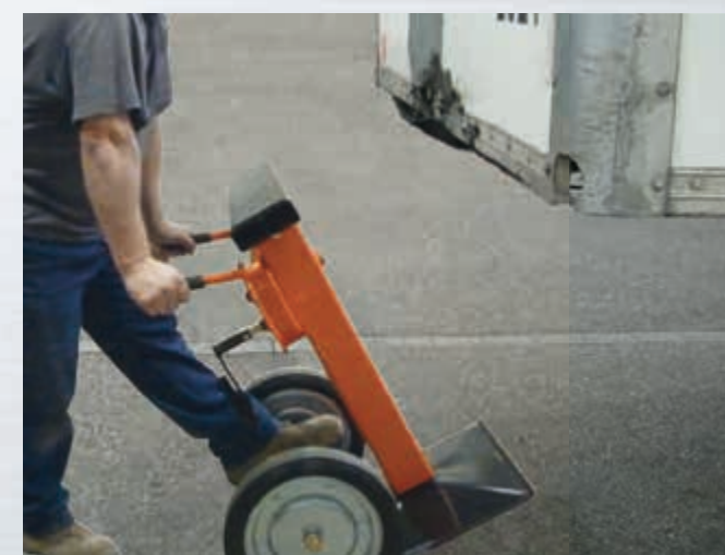
Béquille JACK/TS avec système d'asservissement (monnayeur et détection de présence de remorque)
