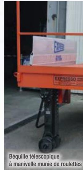
Béquille télescopique à manivelle munie de roulettes
