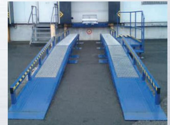
Lorsque les véhicules sont toujours du même type, on peut utiliser des rampes en deux parties spécialement adaptées à leur taille.
