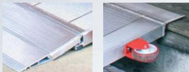
Une butée (côté remorque) et une bande de caoutchouc antidérapante (en contact avec le sol du quai) assurent au pont une stabilité parfaite pendant les opérations de chargement et déchargement. La bande de caoutchouc a aussi une fonction insonorisante.
