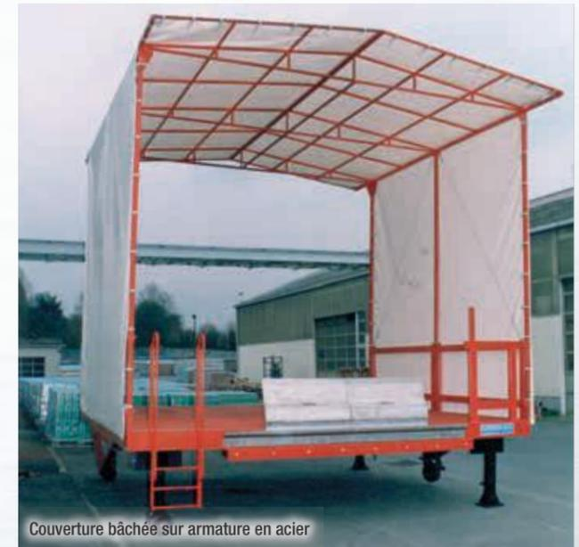
Couverture bâchée sur armature en acier
