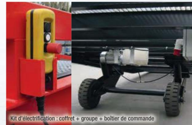
Kit d'électrification : coffret + groupe + boîtier de commande
