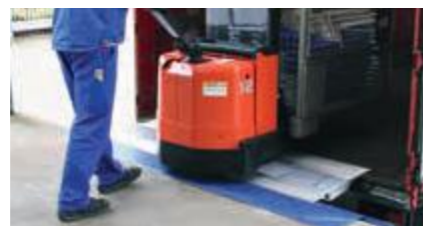
Transpalette électrique (Charge maximum 2500 kg - Pente max. 8%*)
