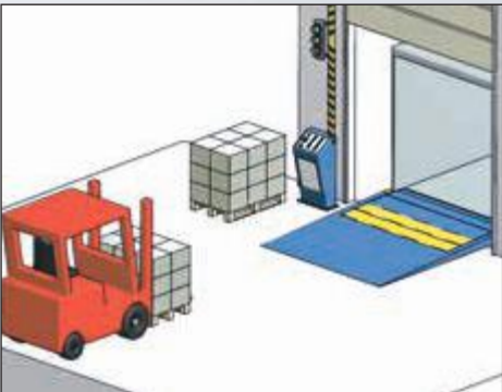
Ensuite, la lèvre de liaison peut être déployée sur le plancher de la remorque afin de finir les opérations de chargement ou déchargement.
