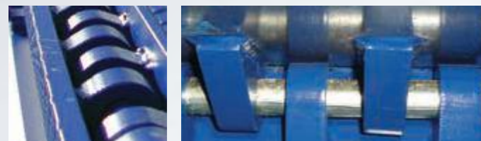
Charnières de levre oxycoupées très résistantes en forme de gouttes d'eau : Plus la charge utile du niveleur augmente et plus le nombre de charnières est grand.
