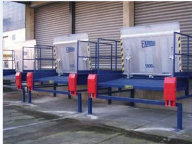
Ponts 8862 sur châssis carénés avec passage de hayon, table arrière et butoirs mobiles
