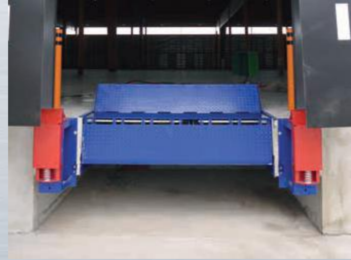
Mise en place du pont : l'obstacle disparaît, en même temps le refuge se comble et permet au chariot de prendre les premières palettes en bout de remorque.
