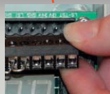
Bornes enfichables pour une installation simple
