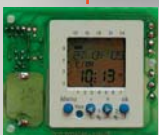
SoCLE pour enficher une minuterie hebdomadaire en option
