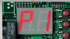
Affichage segmentée 2 x 7, toutes les programmations se font dans un menu d'apprentissage claire
