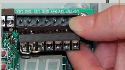
Bornes de raccordement enfichable pour simplifier l'installation
