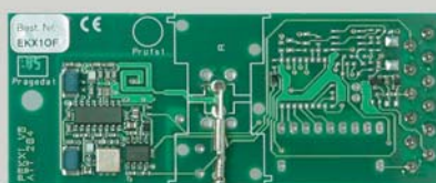
Connexion pour module de feux de circulation en option
